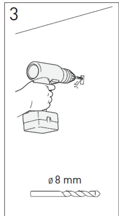
Assurez-vous qu'il n'y ait pas de tuyaux ou de câbles électriques dans le mur. Utilisez un foret adapté au matériau du mur.
