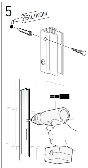
Mettez un peu de silicone dans le trou et utilisez des chevilles et des vis pour le montage du profilé.
