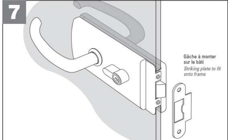
**Graissage :** Pulvériser au moins une fois par an un lubrifiant par l'orifice du 1/2 tour.
