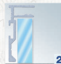
Pose du miroir
